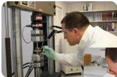
**CR REALIZA LAS PRUEBAS DE LABORATORIO** para determinar las características físicas y químicas de productos tales como resistencias a la compresión, tensión y tensión diametral. También se utiliza la tensión térmica y otros métodos. Los ensayos se realizan para verificar las declaraciones del producto.
