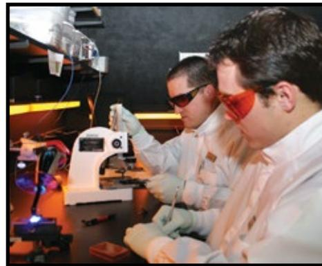
*Este equipo está probando lámparas de polimerización de resina para determinar su habilidad curativa sobre compuestos de resina.*
